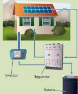
Instalación solar autosuficiente: la vivienda no tiene que estar conectada a la red, produciendo por sí sola la electricidad necesaria para su consumo
