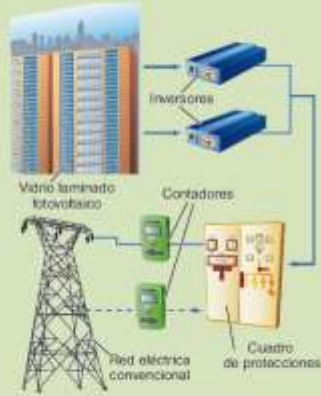
Instalación conectada a la red eléctrica
